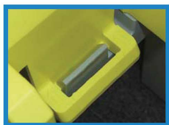
上脚材（イエロー側）のつまみ部分を内側に向かって水平に押すと爪が外れロックが解除される。対面2箇所同時に押して上下操作すること（グレーの爪は押さないこと）。
